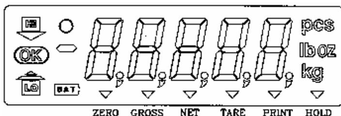
TEST 2. Для выхода из предыдущего тестирования следует нажать клавишу **SET**. На дисплее высветится **TEST 2** а затем – показание текущей нагрузки, например, **5500**. Проверьте, что при изменении нагрузки показания также изменяются.
